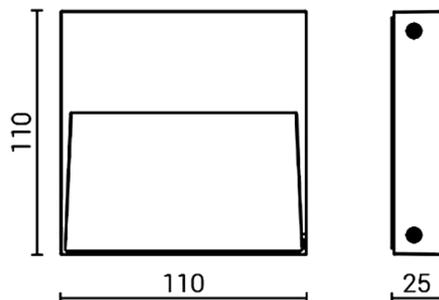
Luminaria de exterior señalador del recorrido para instalación en pared
