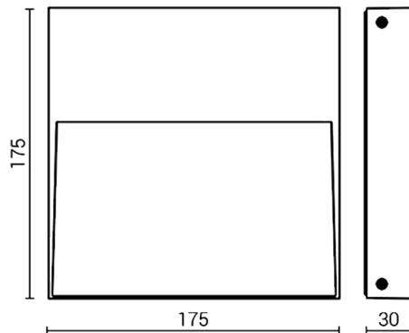
Luminaria de exterior señalador del recorrido para instalación en pared
