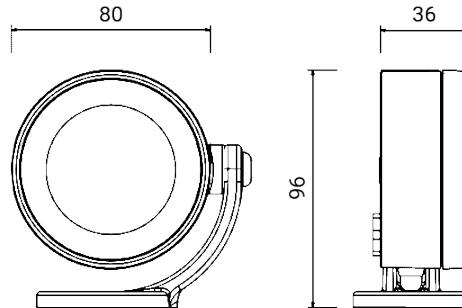
Luminaria tipo spot de exterior para instalación en pared, vástago y suelo
