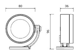
Spot d'extérieur pour installation murale, sur tige et au sol Luminaire orientable avec blocage stable sur le point choisi
