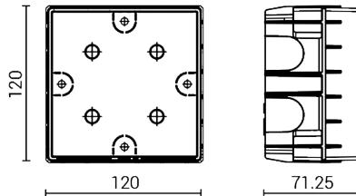
Einbaukasten mit Schutzdeckel für komplette flächenbündige Installation
