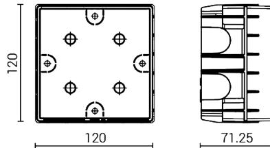
Boîtier pour un encastrement total à ras du mur, fourni avec couvercle
