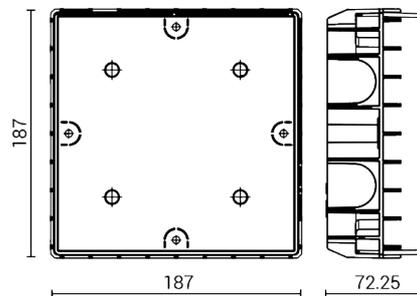
Einbaukasten mit Schutzdeckel für komplette flächenbündige Installation
