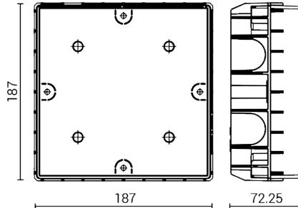
Boîtier pour un encastrement total à ras du mur, fourni avec couvercle
