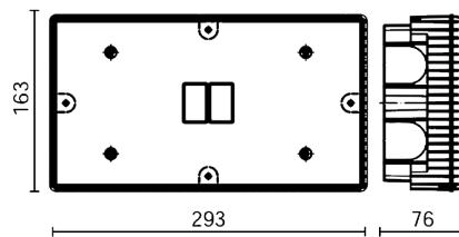
Einbaukasten mit Schutzdeckel für komplette flächenbündige Installation
