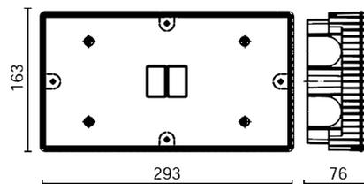
Boîtier pour un encastement total à ras du mur, fourni avec couvercle
