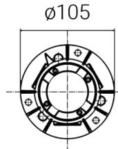
Boîtier d'encastrement pour câblage enterré à installer avec tige
