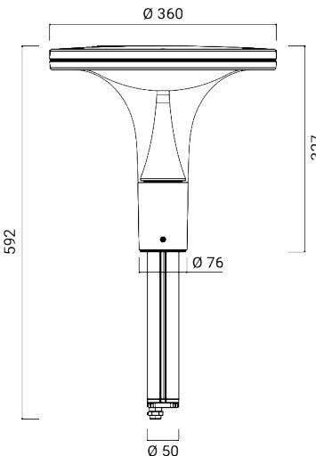
Luminaire d'extérieur pour installation sur poteau
