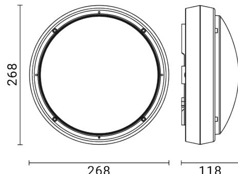
Luminaire d'extérieur pour installation au mur/plafond
