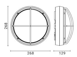
Luminaria de exterior para instalación en pared/techo
