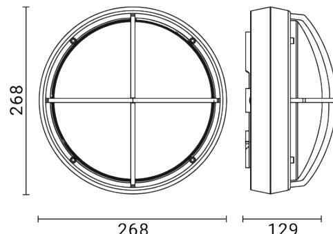
Luminaire d'extérieur pour installation au mur/plafond
