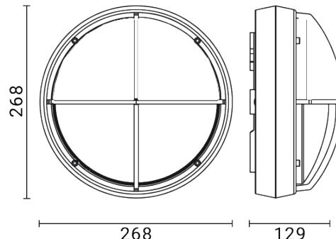
Luminaire d'extérieur pour installation au mur/plafond
