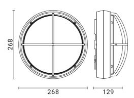
Luminaire d'extérieur pour installation au mur/plafond
