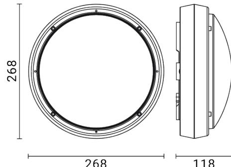
Luminaria de exterior para instalación en pared/techo
