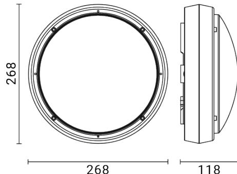
Luminaire d'extérieur pour installation au mur/plafond
