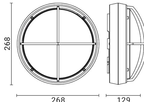
Luminaria de exterior para instalación en pared/techo
