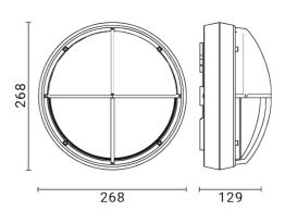
Luminaire d'extérieur pour installation au mur/plafond
