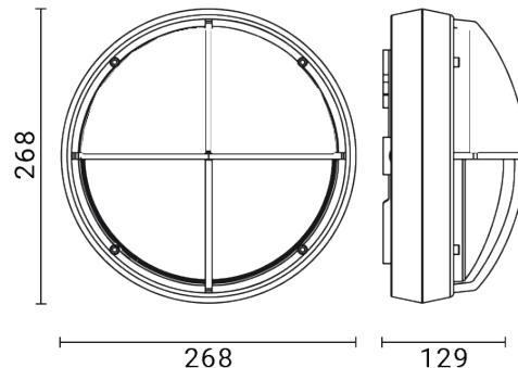
Luminaire d'extérieur pour installation au mur/plafond
