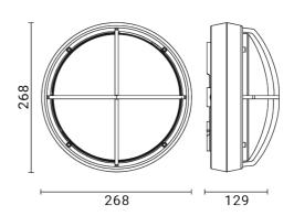
Luminaire d'extérieur pour installation au mur/plafond
