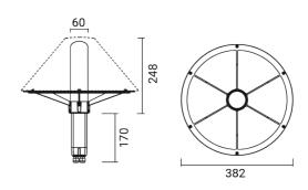
Luminaire d'extérieur pour installation sur poteau et au mur
