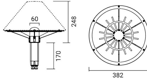
Luminaria de exterior para instalación en poste/pared
