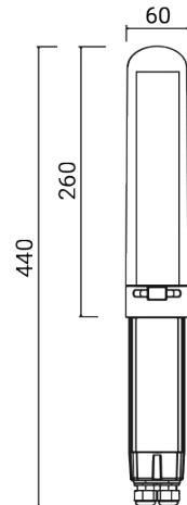
Luminaria de exterior para instalación en poste/pared
