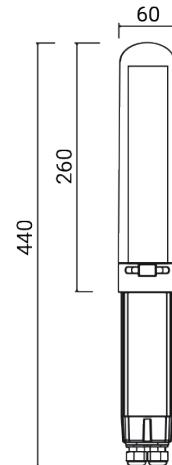
Luminaire d'extérieur pour installation sur poteau et au mur
