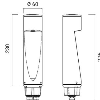
Luminaire d'extérieur pour installation sur poteau
