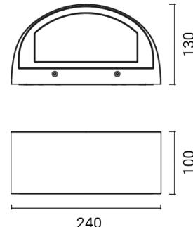
Luminaria de exterior para instalación en pared
