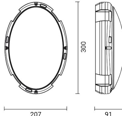
Luminaire d'extérieur pour installation au mur/plafond
