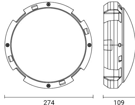
Luminaire d'extérieur pour installation au mur/plafond
