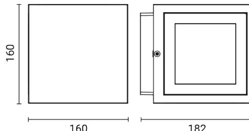
Luminaire d'extérieur pour installation au mur/au sol
