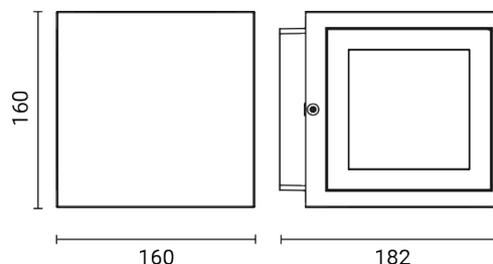
Luminaria de exterior para instalación en pared/suelo
