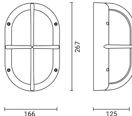
Luminaire d'extérieur pour installation au mur/plafond
