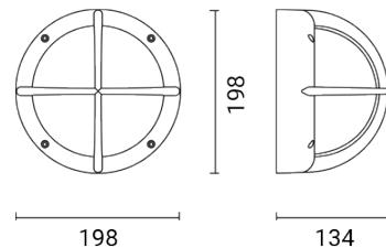
Luminaire d'extérieur pour installation au mur/plafond
