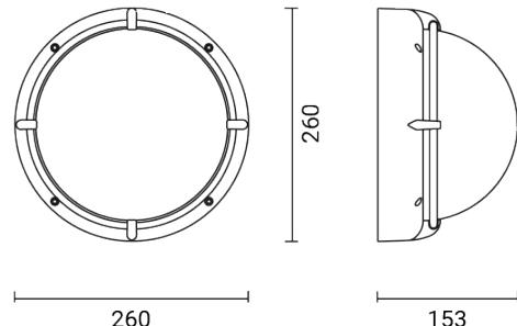
Luminaria de exterior para instalación en pared/techo
