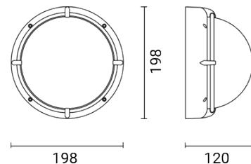
Luminaire d'extérieur pour installation au mur/plafond
