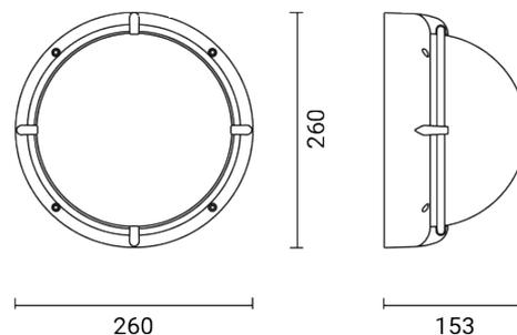
Luminaria de exterior para instalación en pared/techo
