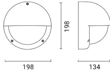
Luminaire d'extérieur pour installation au mur/plafond
