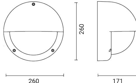
Luminaire d'extérieur pour installation au mur/plafond
