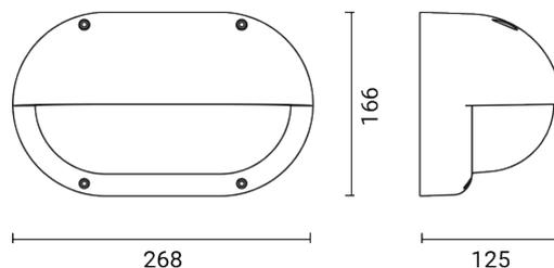
Luminaria de exterior para instalación en pared
