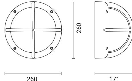
Luminaria de exterior para instalación en pared/techo
