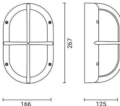
Luminaire d'extérieur pour installation au mur/plafond
