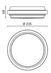
Luminaire d'extérieur pour installation au mur/plafond
