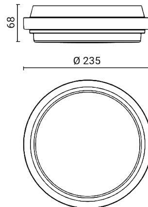
Luminaire d'extérieur pour installation au mur/plafond
