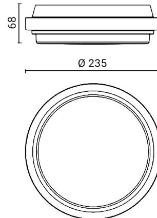
Luminaire d'extérieur pour installation au mur/plafond
