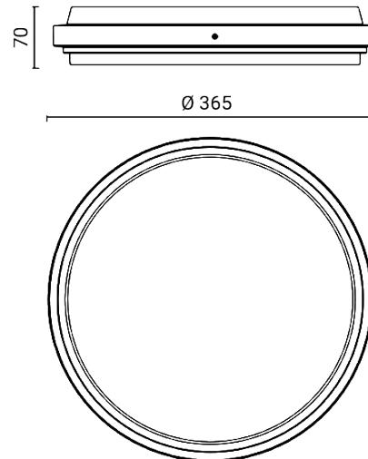
Luminaria de exterior para instalación en pared/techo
