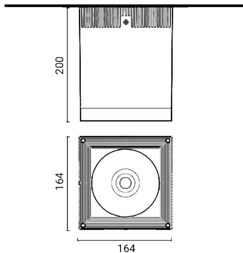
Luminaire d'extérieur pour installation au plafond
