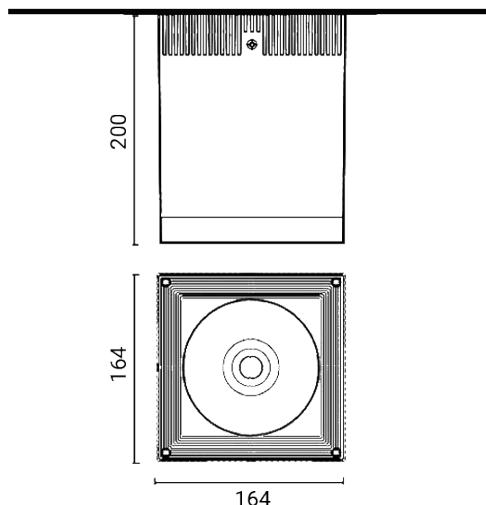
Apparecchio illuminante da esterno per installazione a soffitto
