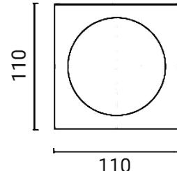
Apparecchio illuminante da esterno per installazione a soffitto
