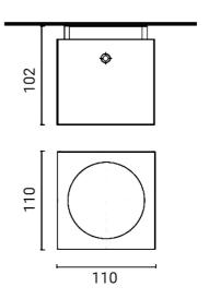
Apparecchio illuminante da esterno per installazione a soffitto
