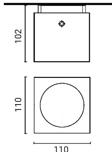
Luminaire d'extérieur pour installation au plafond
